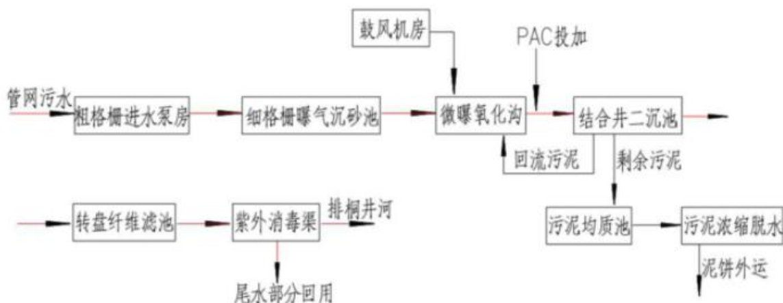
图 6.3-2 棠下污水处理厂一期工程污水处理工艺
