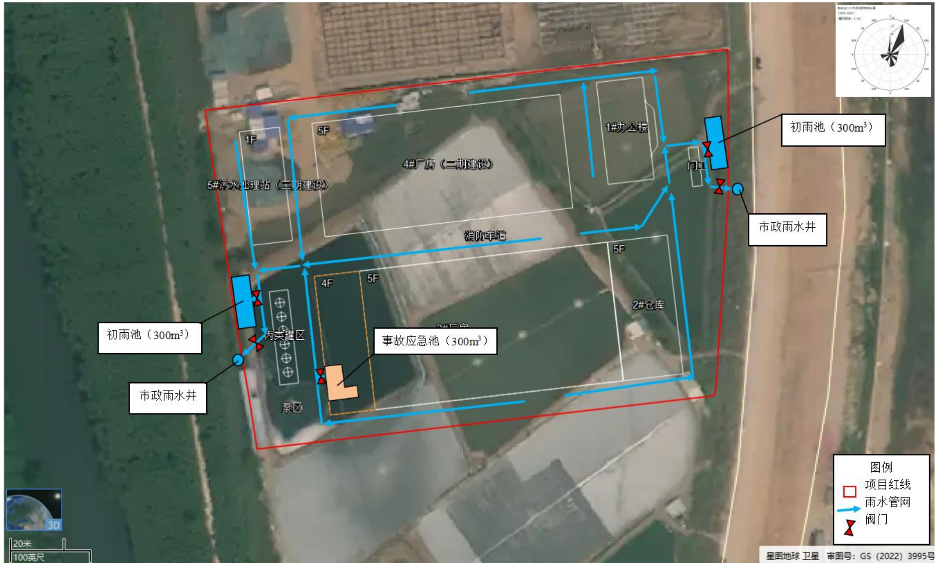
图 8.8-2 项目雨水管网图
