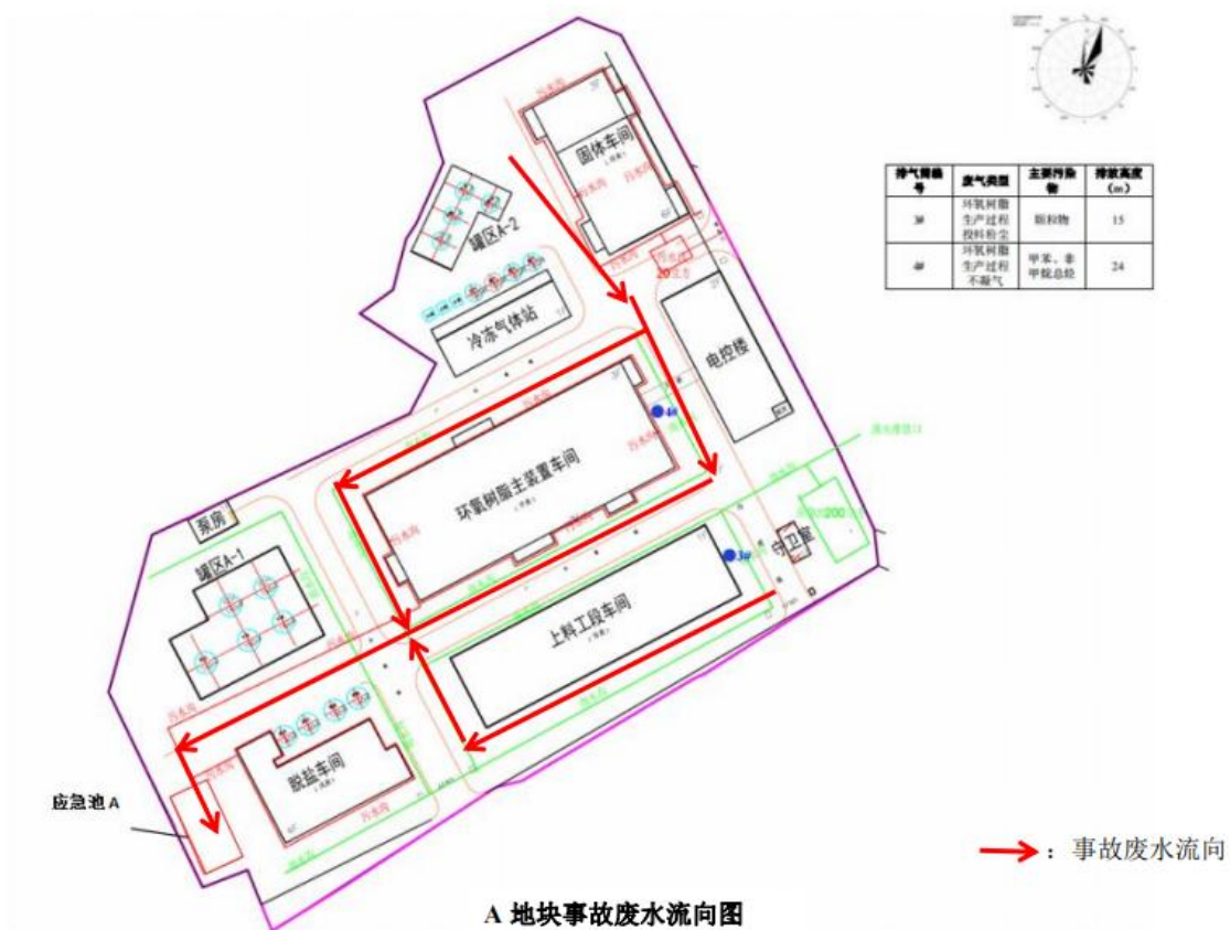
图 7.3-99 A 地块事故废水管网图
