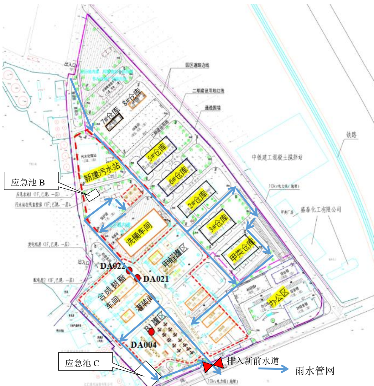
图 7.3-97 B 地块雨水管网图
