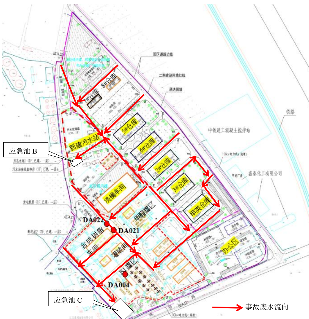
图 7.3-100 B 地块事故废水管网图
