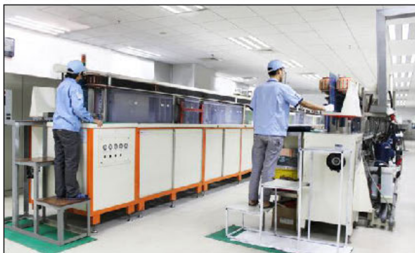
图 1.2.6-2 (b) 同类项目电镀银、金手指线设备图
