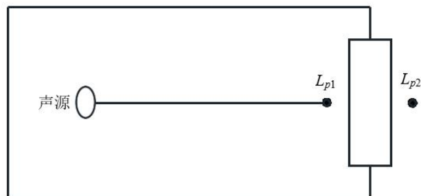
图 6.3-1 室内声源等效为室外声源图例
