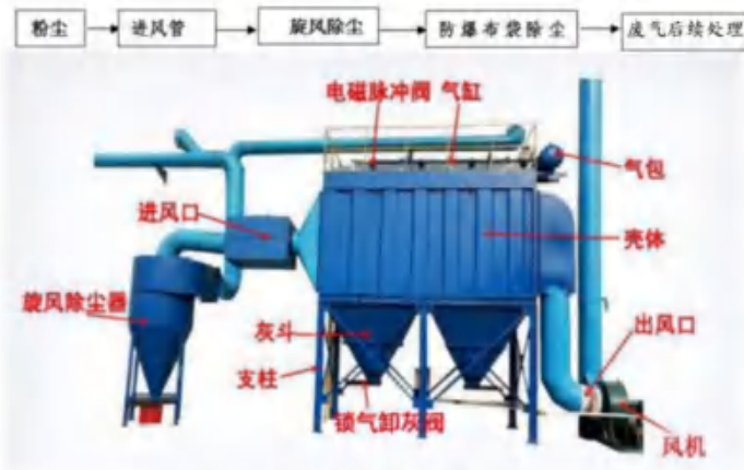
图 10.2-4 布袋除尘装置示意图
