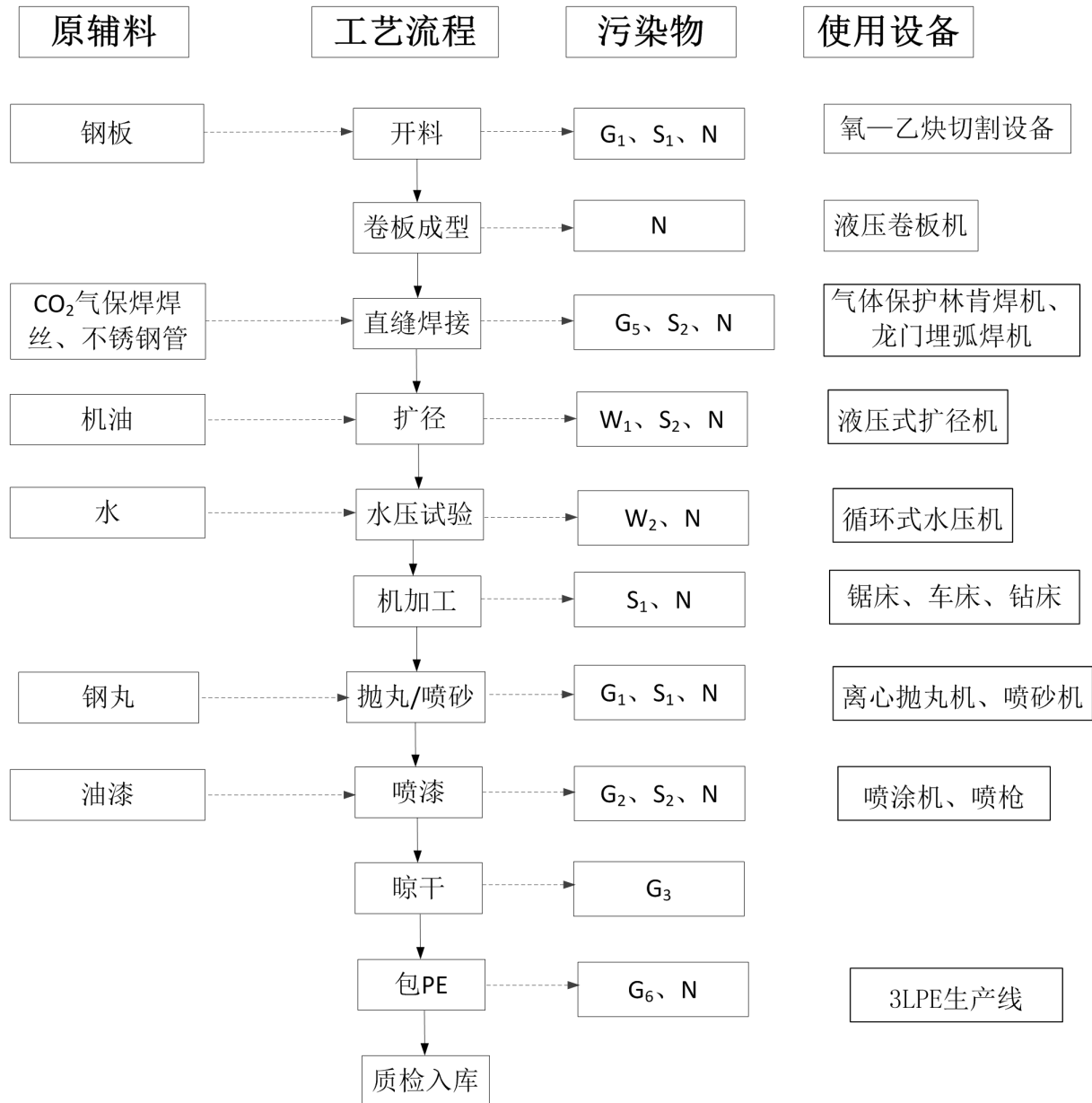
图 3.3-2 钢管及钢结构件生产工艺流程及产污分析图
