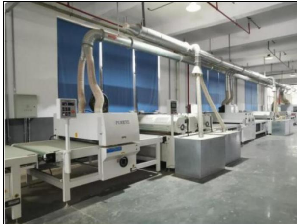
图6.2-3 辊涂线废气收集示意图
