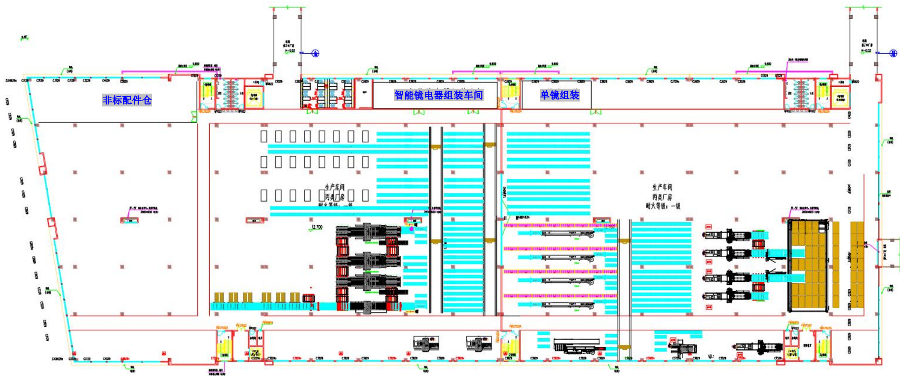
图 3.2-5 常规浴室柜生产车间（1#三层）平面布置图
