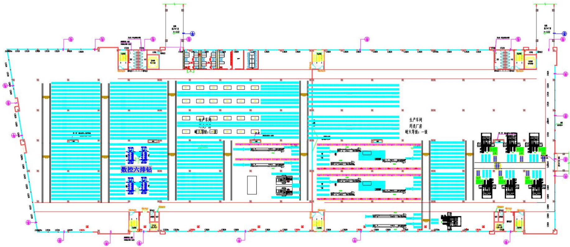
图 3.2-6 非标浴室柜生产车间（1#四层）平面布置图
