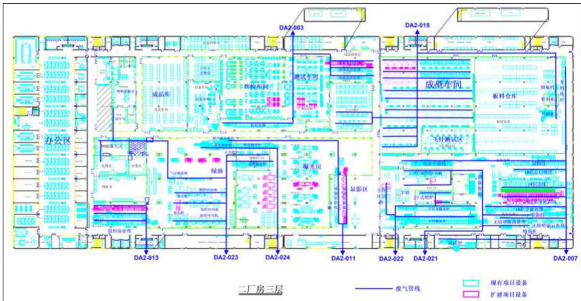
图 12.7-4 (c) 本项目改扩建后全厂废气收集管线分布图——厂房二(三层)
