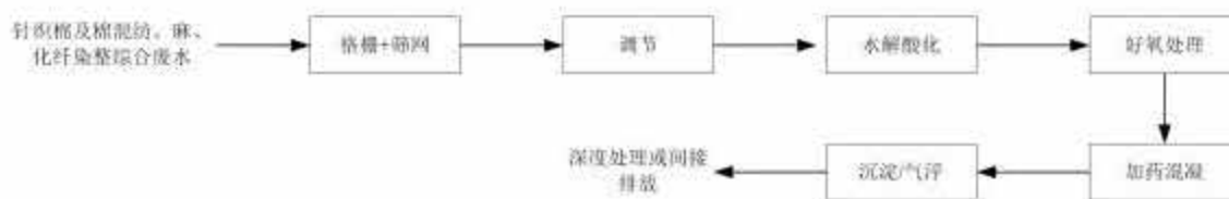
图 8.1-3 针织棉及棉混纺染整、麻染整及化纤染整的综合废水常规处理工艺流程图
