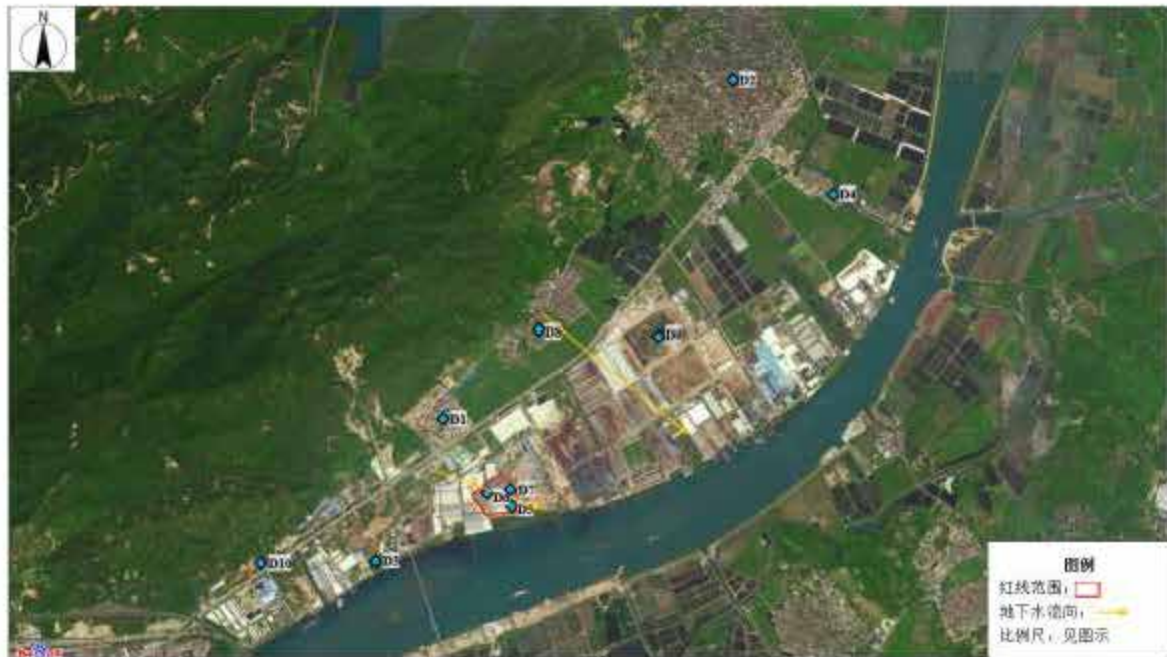
图 5.2-4 地下水位流向图
