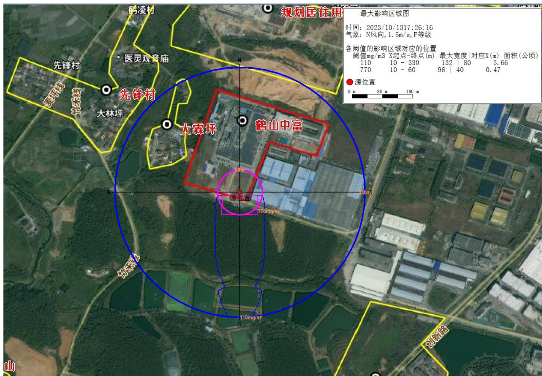
图 3.6-6 最不利气象条件下，液氨储罐泄漏事故最大影响范围图
