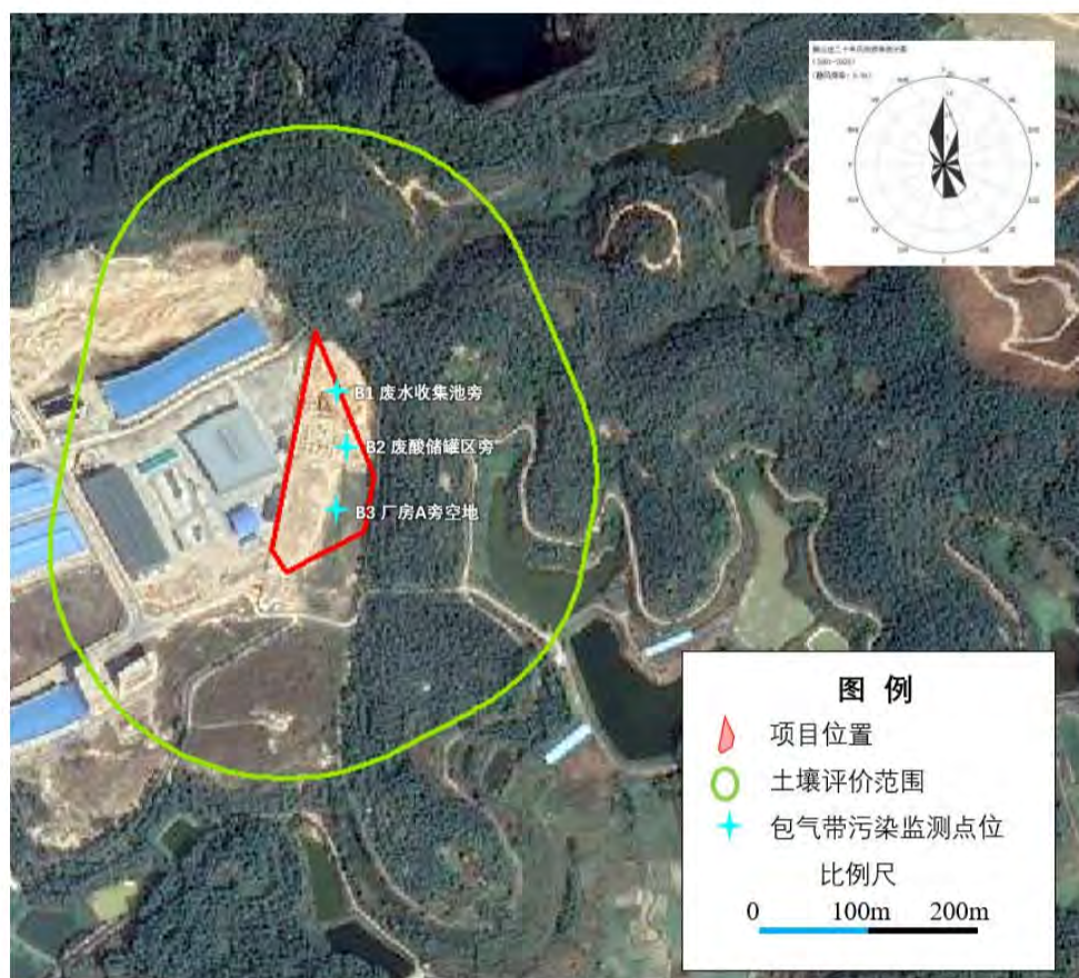
图 4.3.10-1 包气带污染现状调查监测点位示意图
