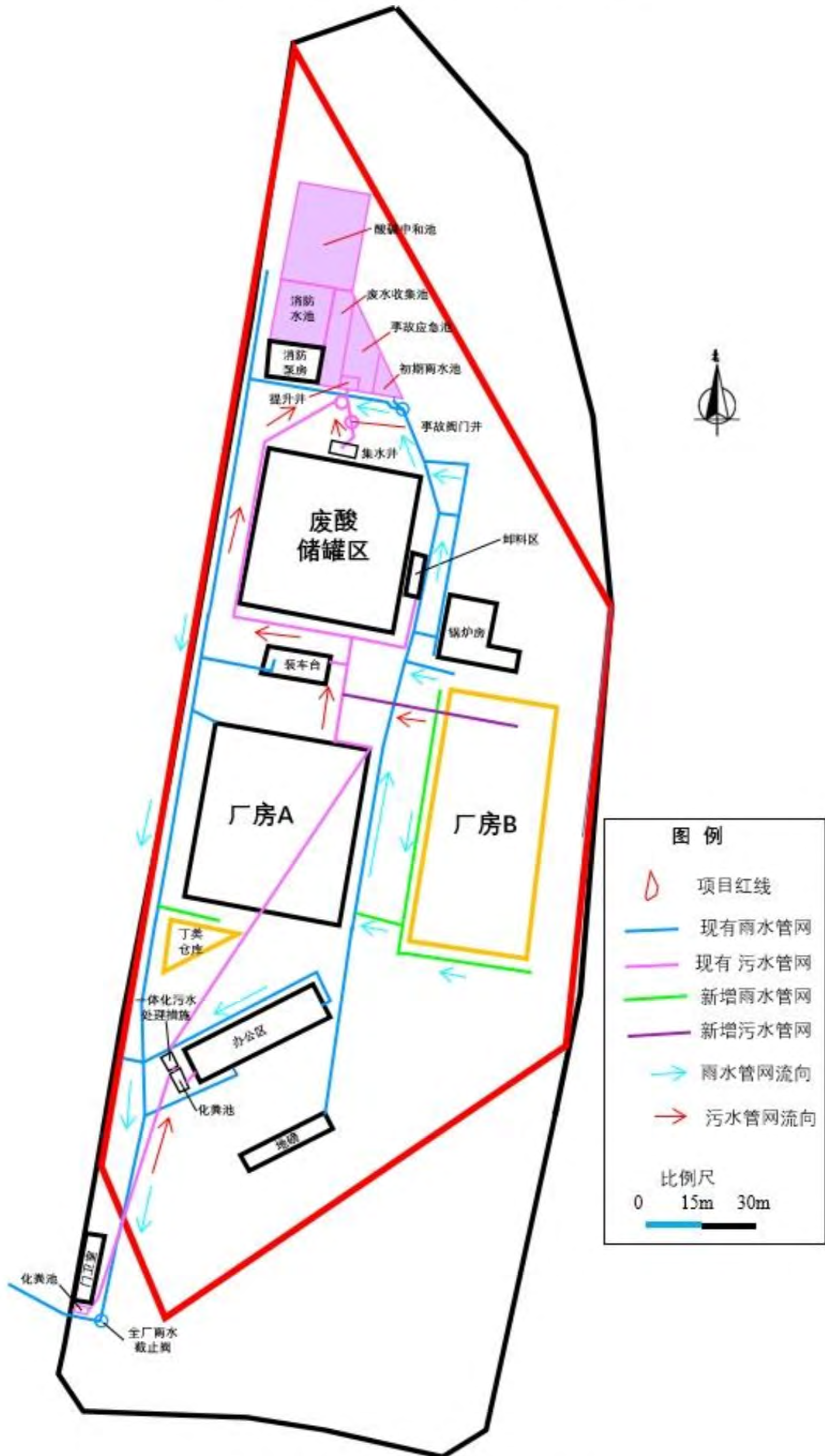
图 3.2.7-3 扩建后全厂雨污水管网平面布置图
