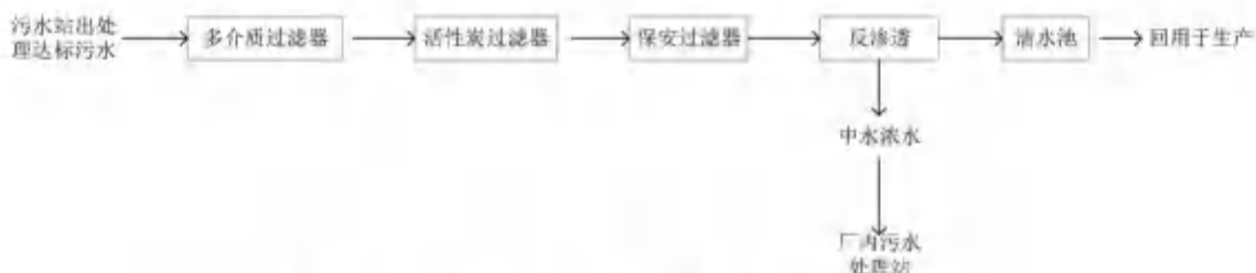
图 3.10.2-2 现有项目中水处理工艺流程图
