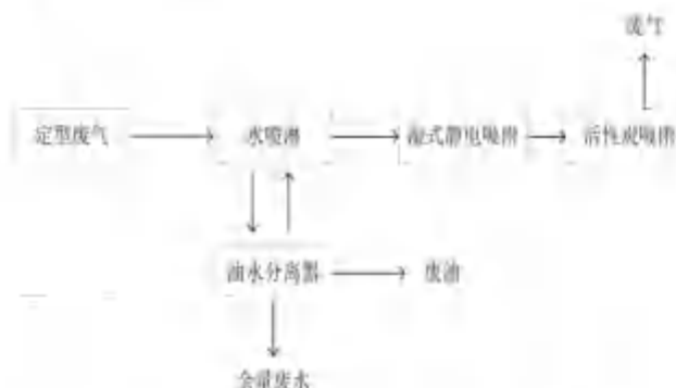
图 9.2.2-1 定型机废气处理工艺流程图
