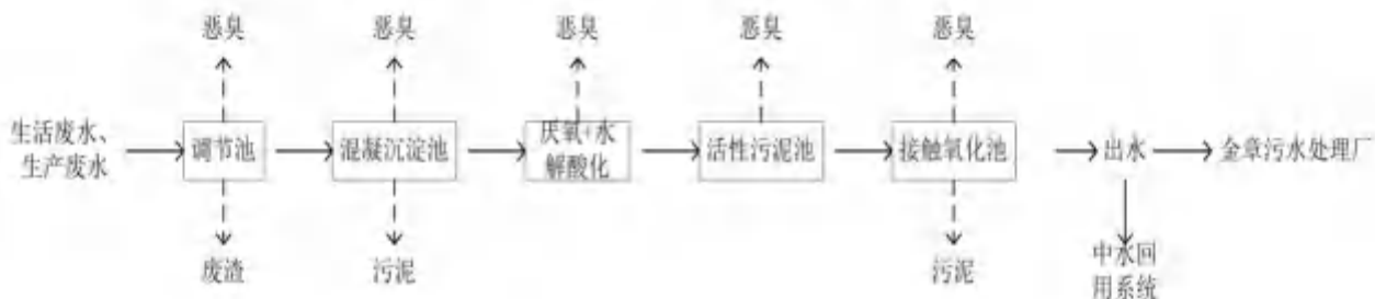
图 3.10.2-1 现有项目废水处理工艺流程图
