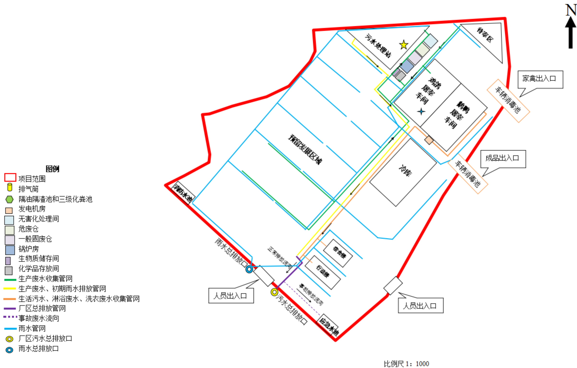
图 3.1-6. 项目污水管网走向图
