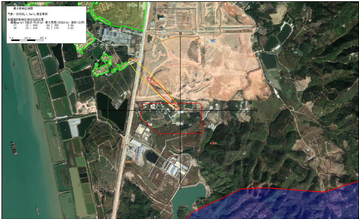
图 5.6-7.4 泄露释放的己二腈超过阈值的最大轮廓图
