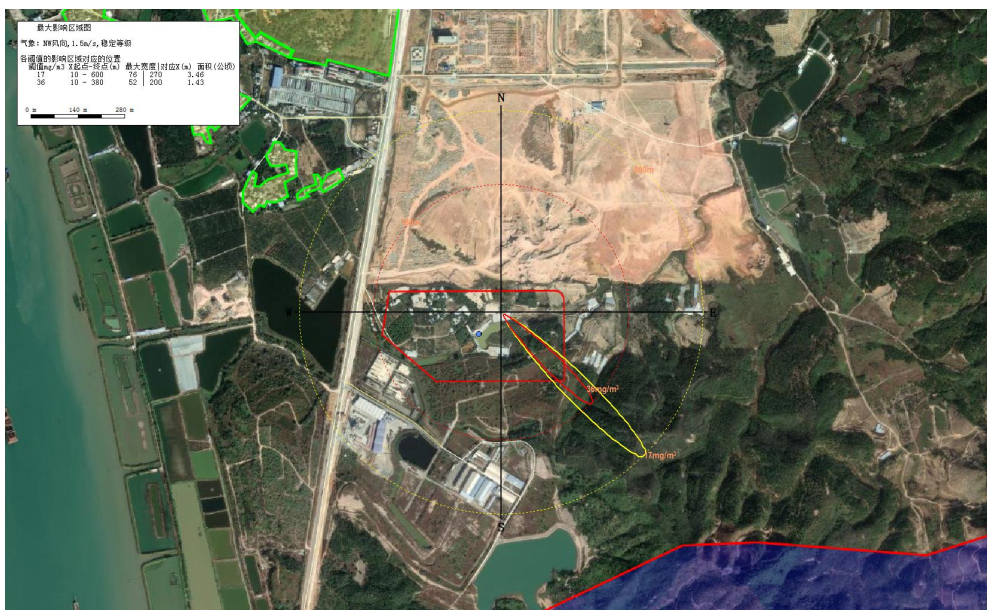
图 5.6-7.18 泄露释放的己二腈超过阈值的最大轮廓图
