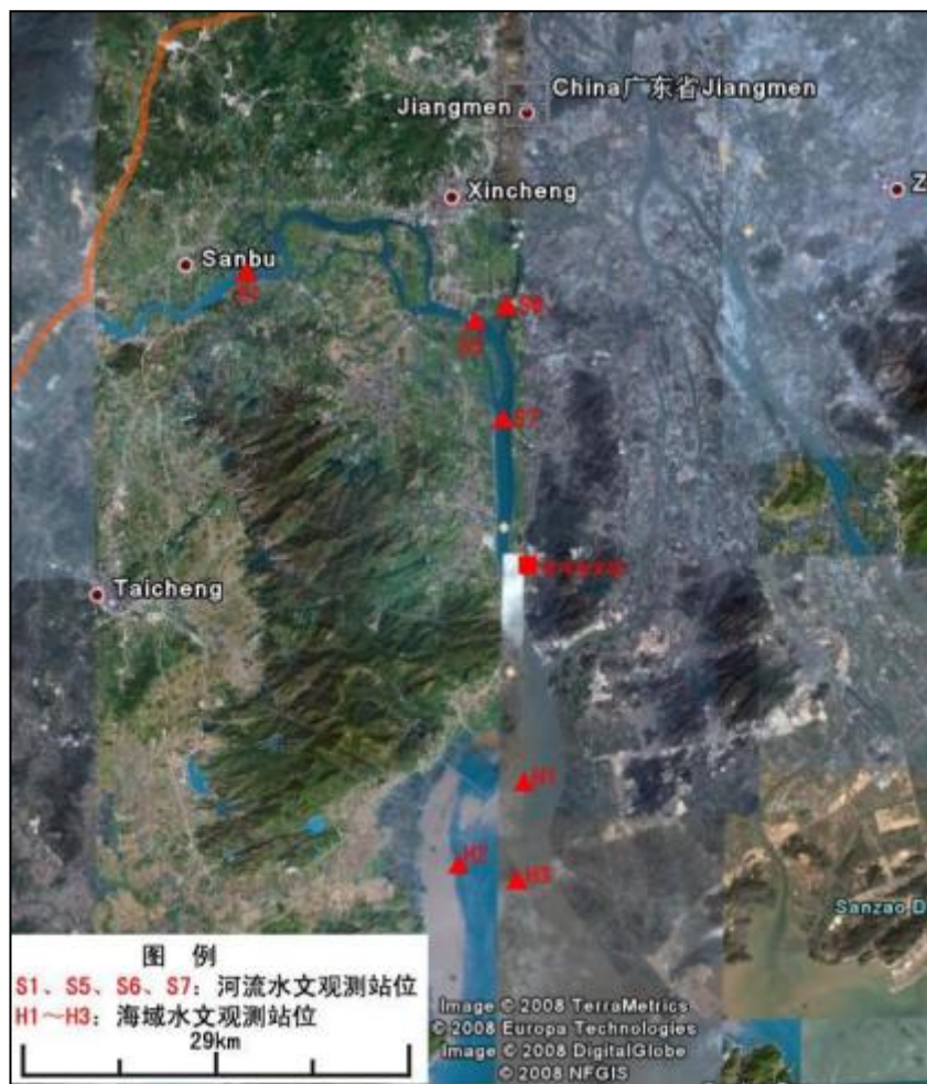
图 5.6-6.1 水文观测站位布设示意图
