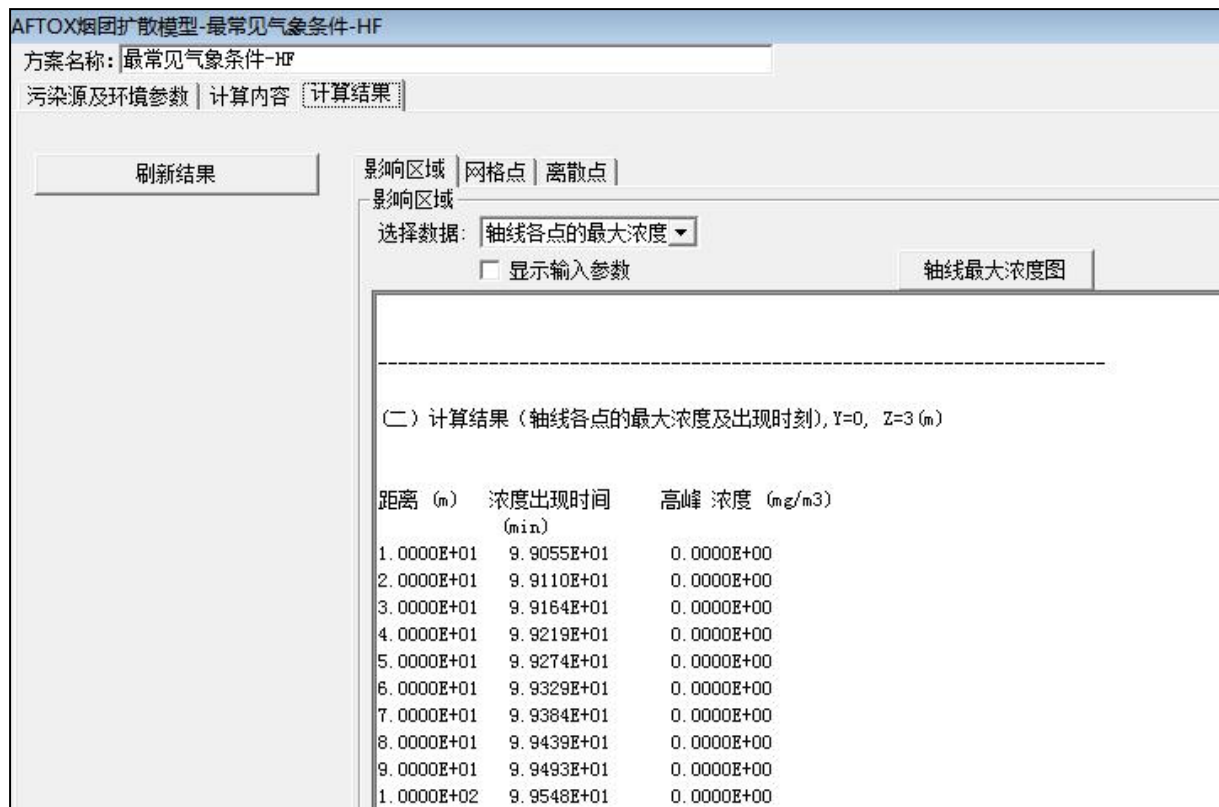
图 5.6-7.25 下风向不同距离处废气装置事故排放情况下释放的 HF 的最大浓度值
