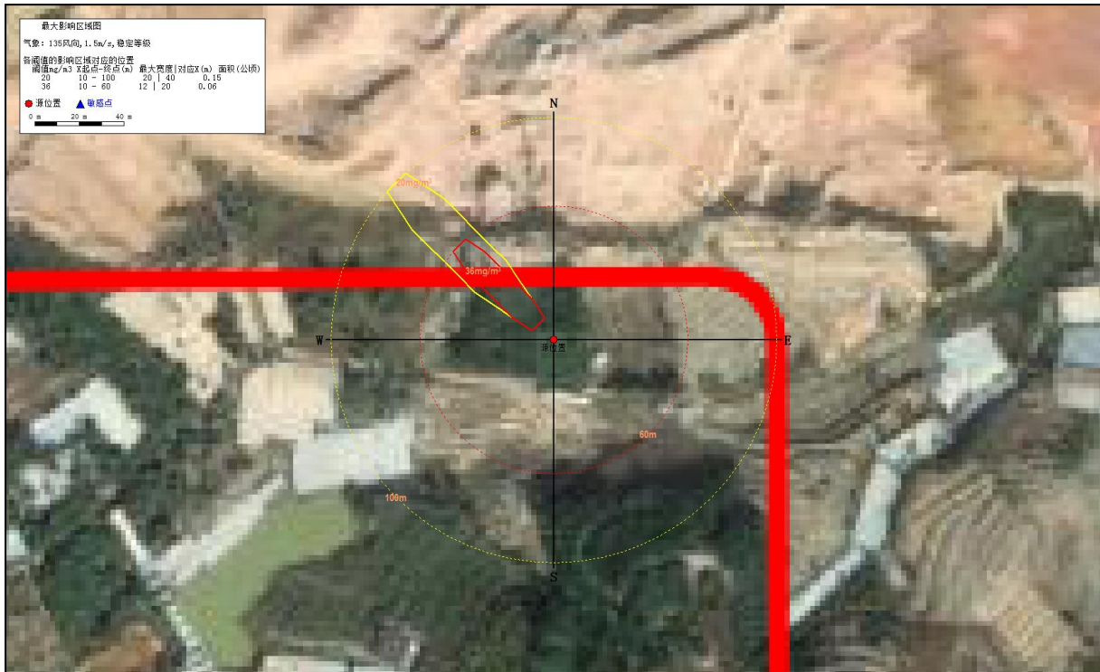
图 5.6-7.10 火灾爆炸情况下释放的 HF 超过阈值的最大轮廓图
