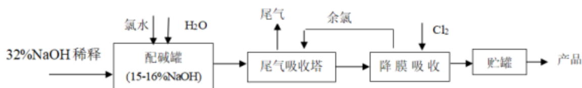
图 3.2-5 次氯酸钠生产工艺流程图
