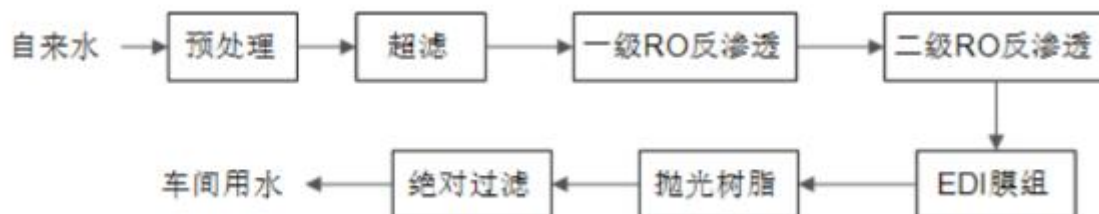
图3.5-1 配套纯水工艺流程图
