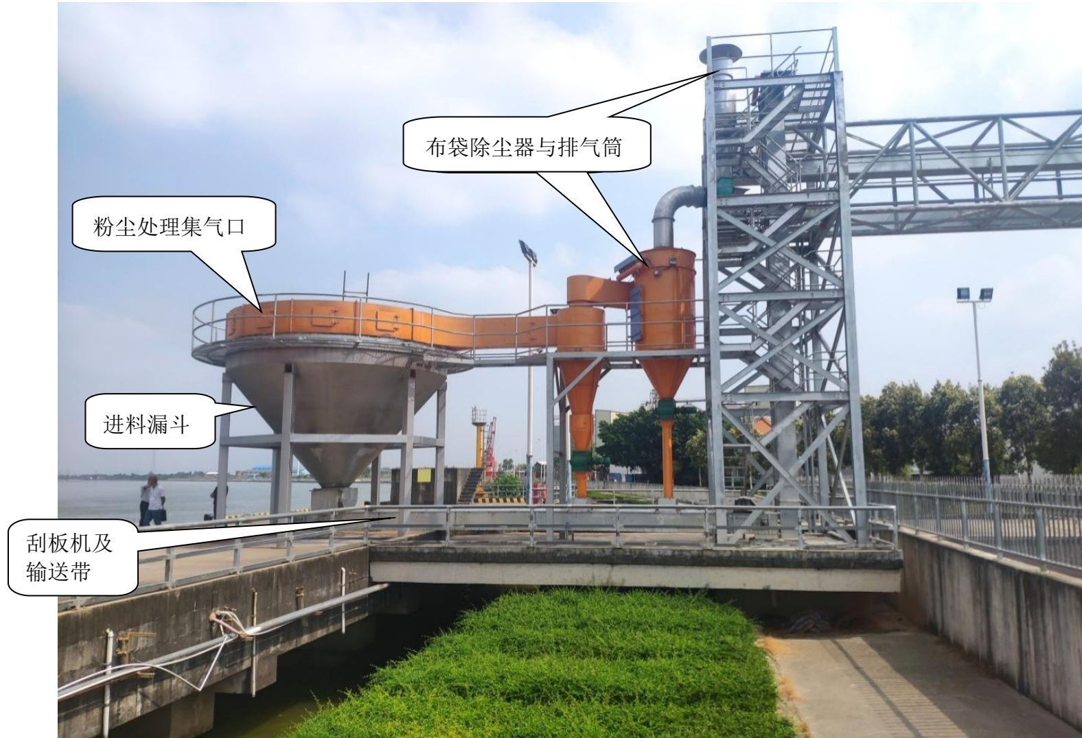
图 4.5-2 卸船工艺设施图
