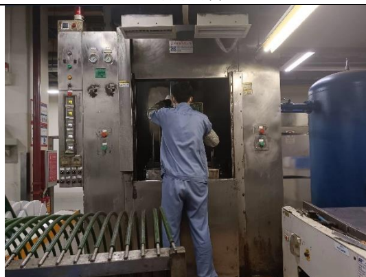
喷锡机三面围蔽的集气罩
