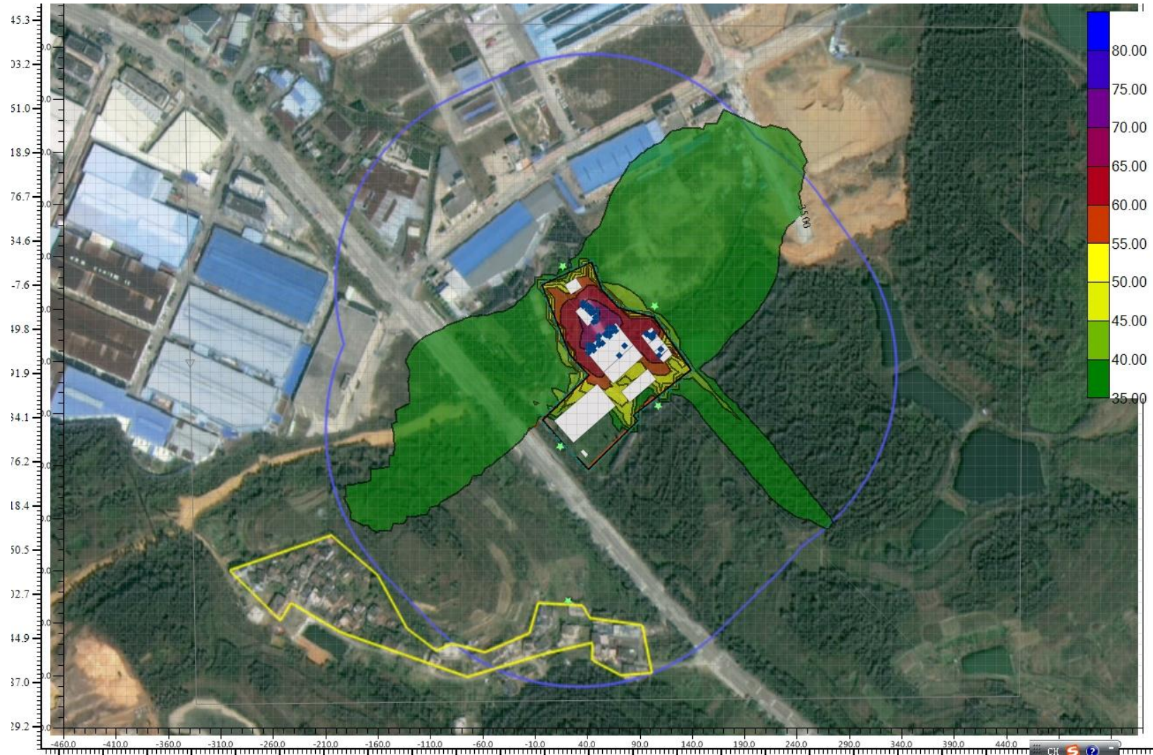
图 6.4-1 项目噪声贡献值等值线图 单位：dB (A)
