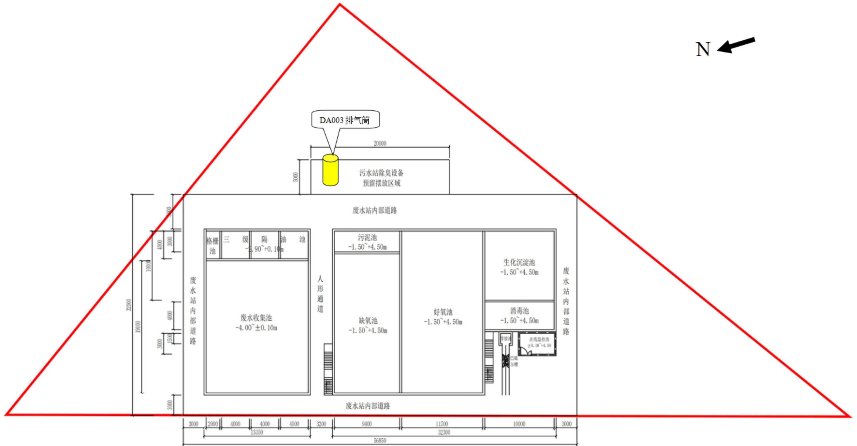
图 3.1-5. 项目污水处理站平面布置图
