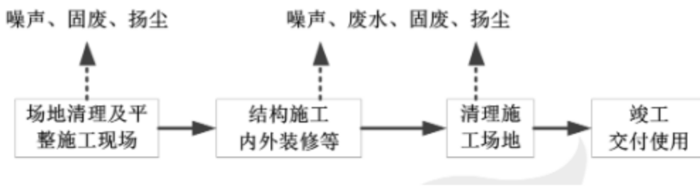
图 3.3-1. 施工期流程及产污环节图
