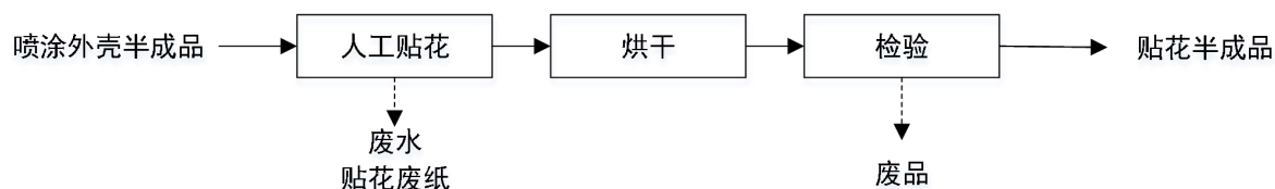
图 3-10 贴花工艺流程及产污环节图
