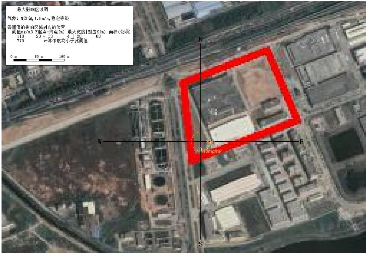
图 3.5.1-5 氨水泄漏事故排放在下风向最大影响区域图（最不利气象条件）
