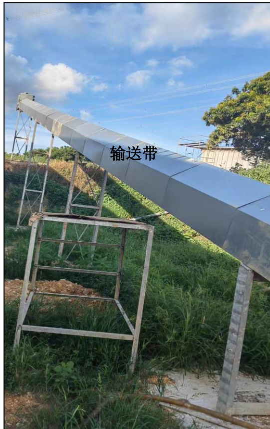
图 3.3-3 输送带封闭设计实物示意图
