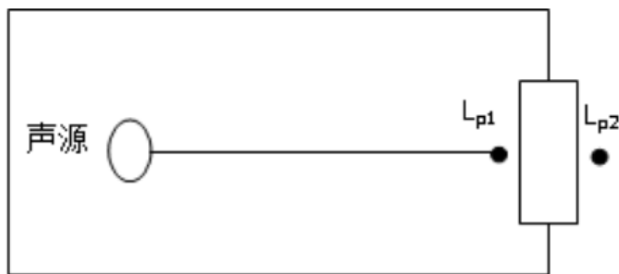
图 6.3-1 室内声源等效为室外声源图例
