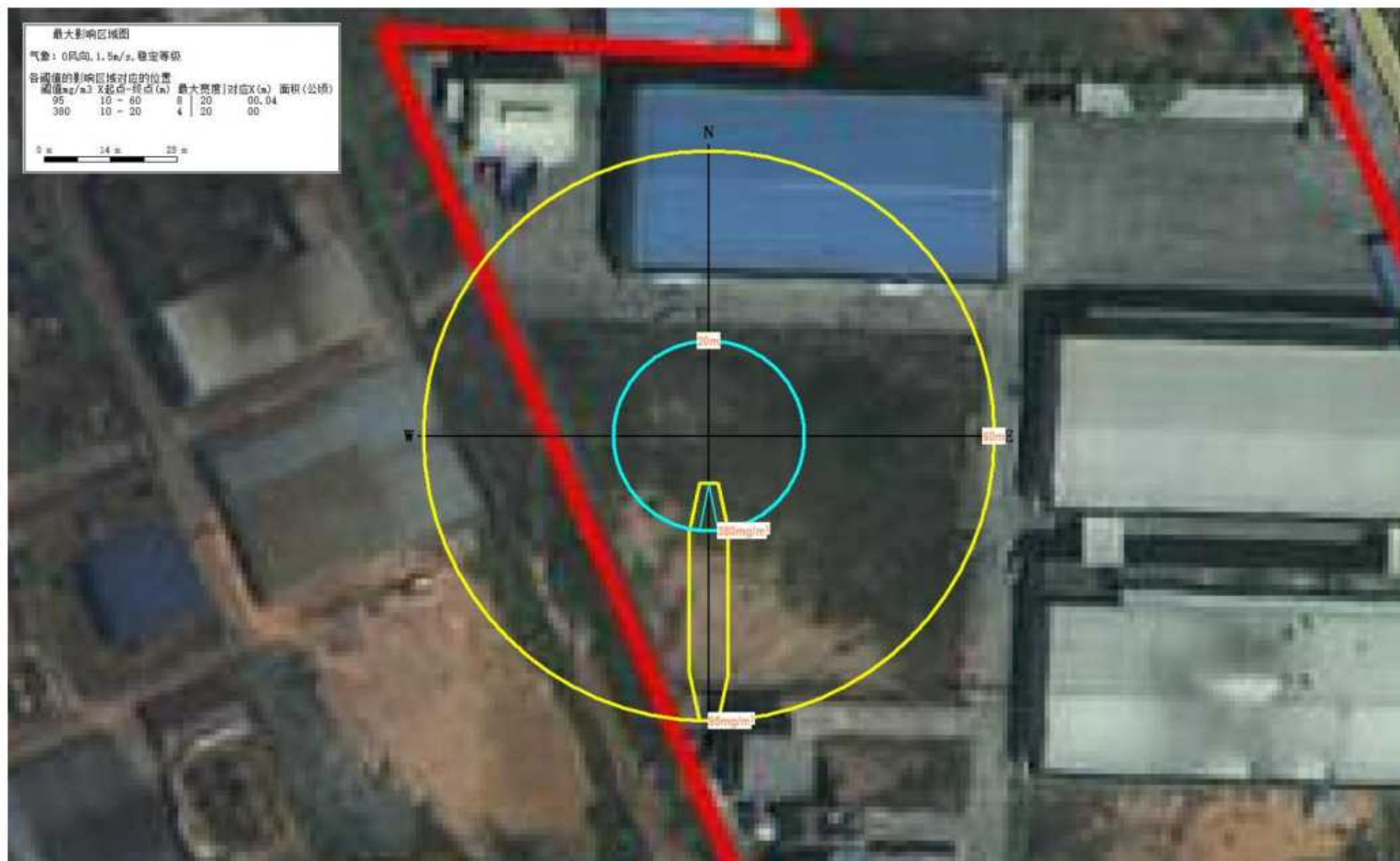
图 6.6-3 最不利气象条件下, CO 扩散毒性终点轮廓线图
