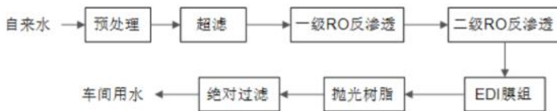
图3.5-1 配套纯水工艺流程图
