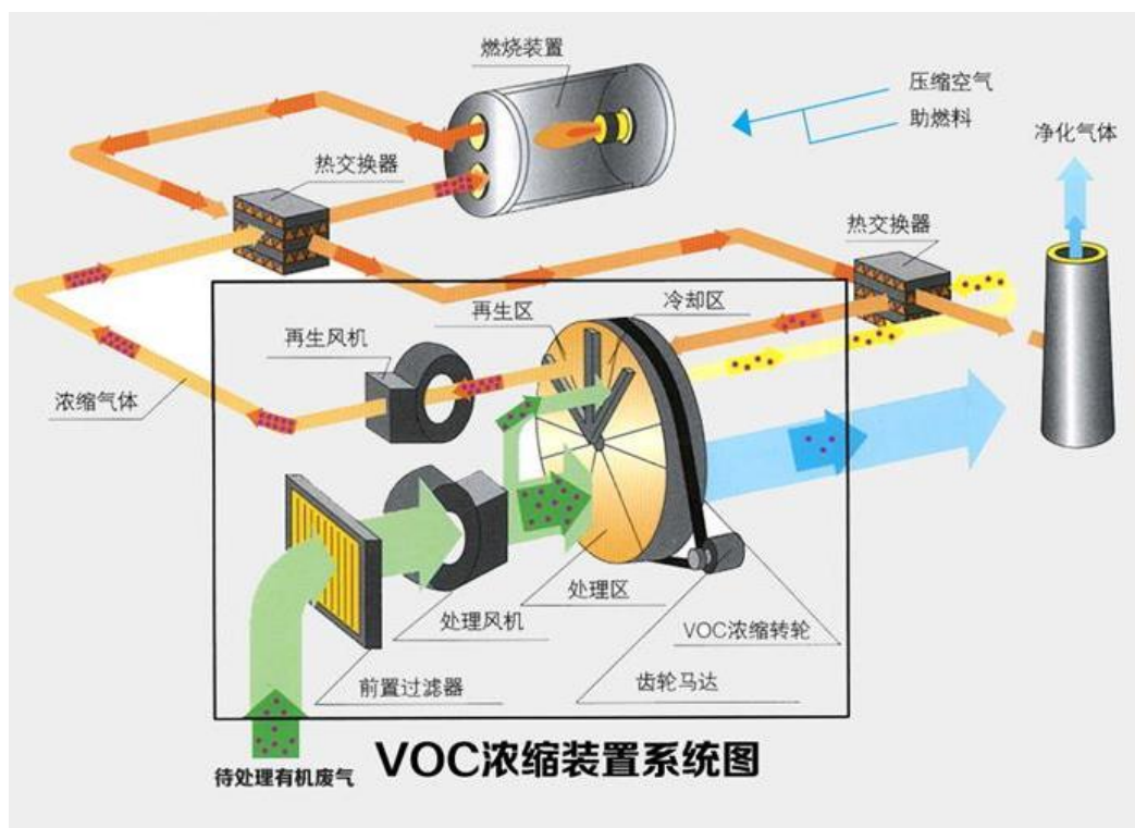
图8-1 吸附吹脱焚烧处置工艺流程图
