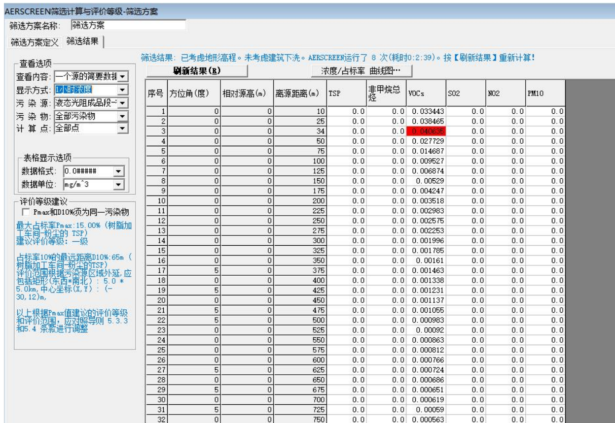
图2.5-15 液态光阻成品段-有机废气污染物排放预测情况 (小时浓度)
