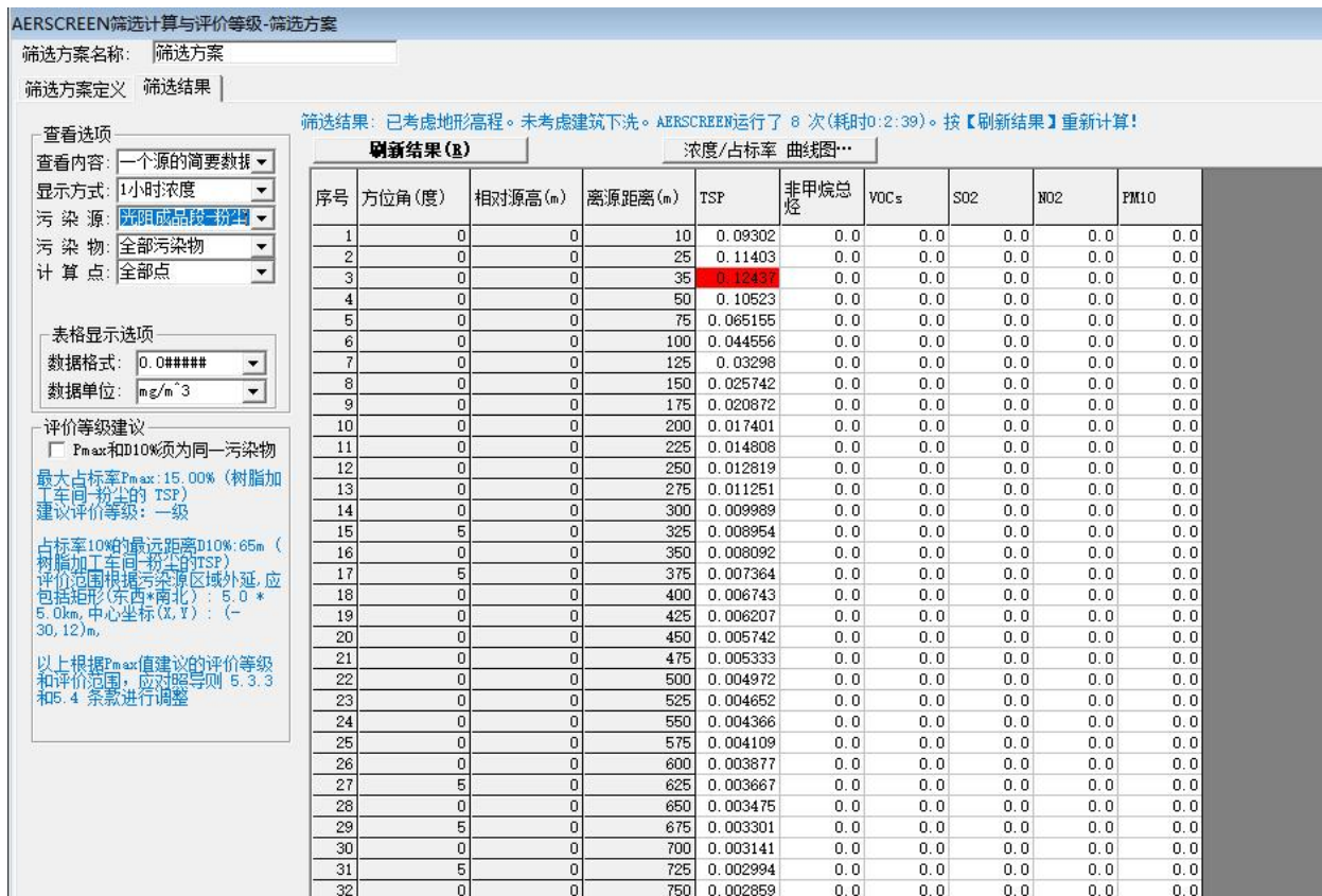
图2.5-17 液态光阻成品段-粉尘污染物排放预测情况 (小时浓度)
