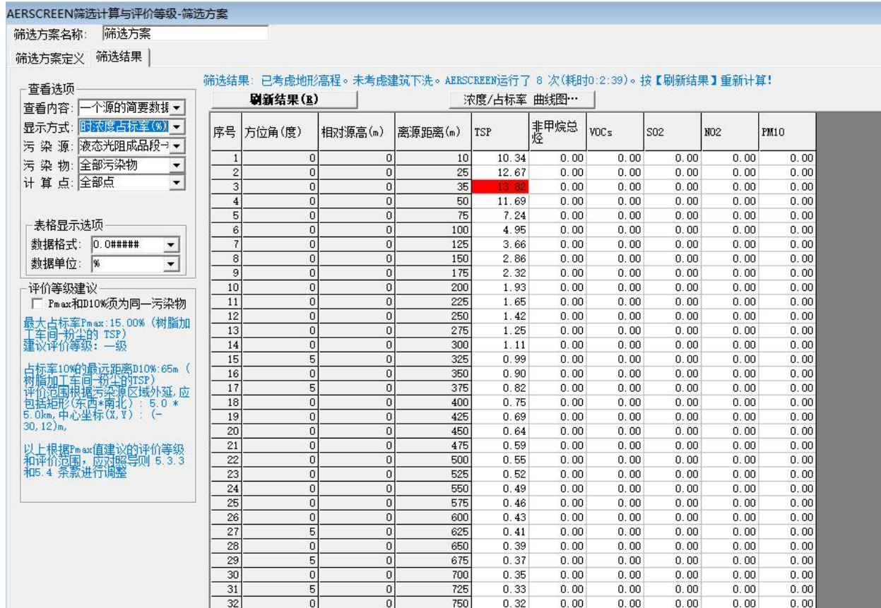
图2.5-16 液态光阻成品段-粉尘污染物排放预测情况 (占标率)
