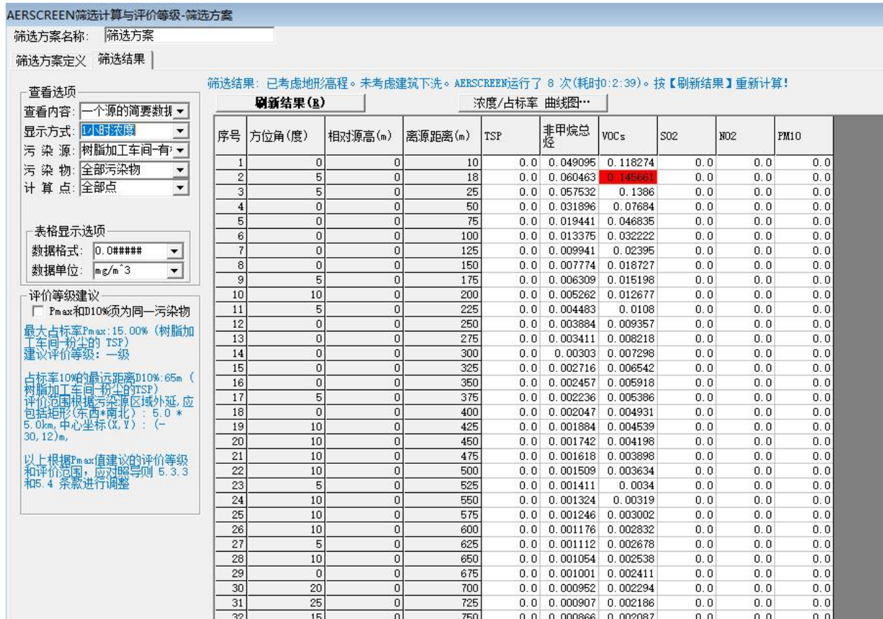
图2.5-11 树脂加工车间-有机废气污染物排放预测情况 (小时浓度)
