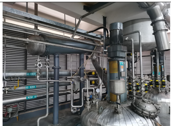
树脂生产线-反应釜配套冷凝管
