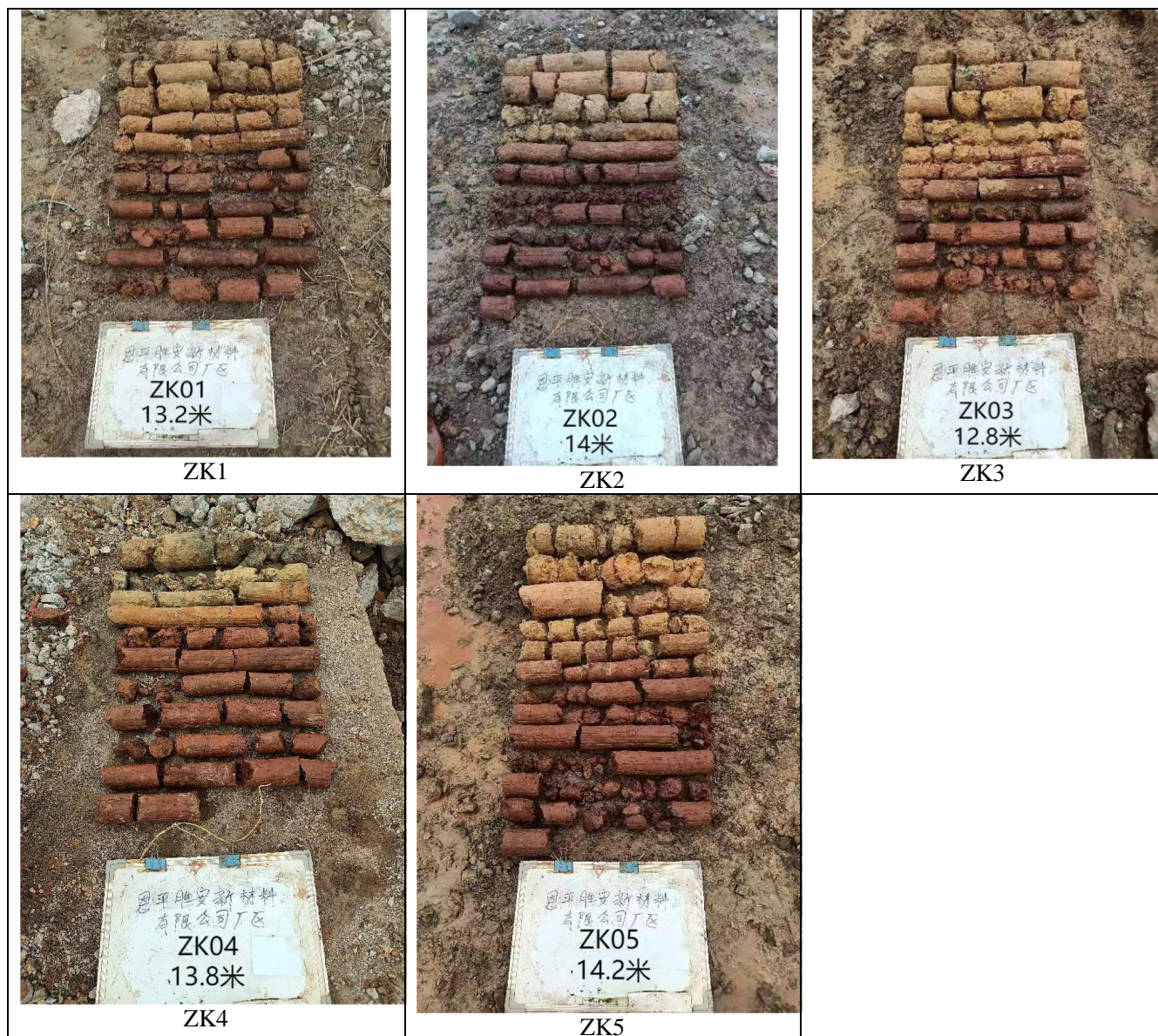
图 6.3.3-1 建设场地岩土工程勘察钻孔岩心照片
