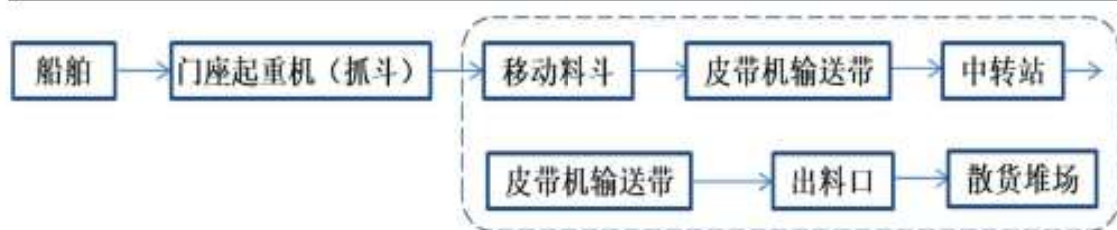
图 2.6-3 2#泊位进口砂、海砂（进）工艺流程〔 〕内不在本次评价范围
