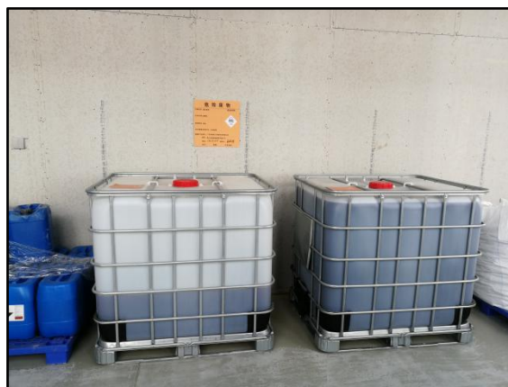
危废暂存处内废槽液
