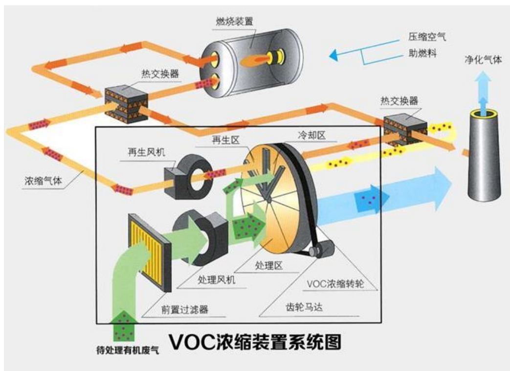
图9-1 吸附吹脱焚烧处置工艺流程图
