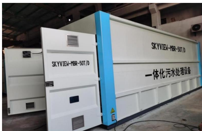
图 3.1-2 一体化污水处理设施装置
