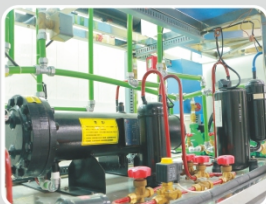
中央空调实训装置
