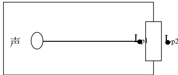
图 7.4-1 室内声源等效为室外声源图例
