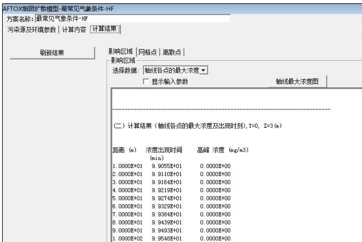
图 5.6-3.9 下风向不同距离处废气装置事故排放情况下释放的 HF 的最大浓度值
