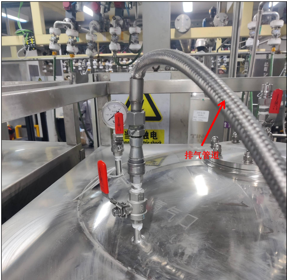
图 6.2-1 项目电解液灌装工序废气收集方式示意图
