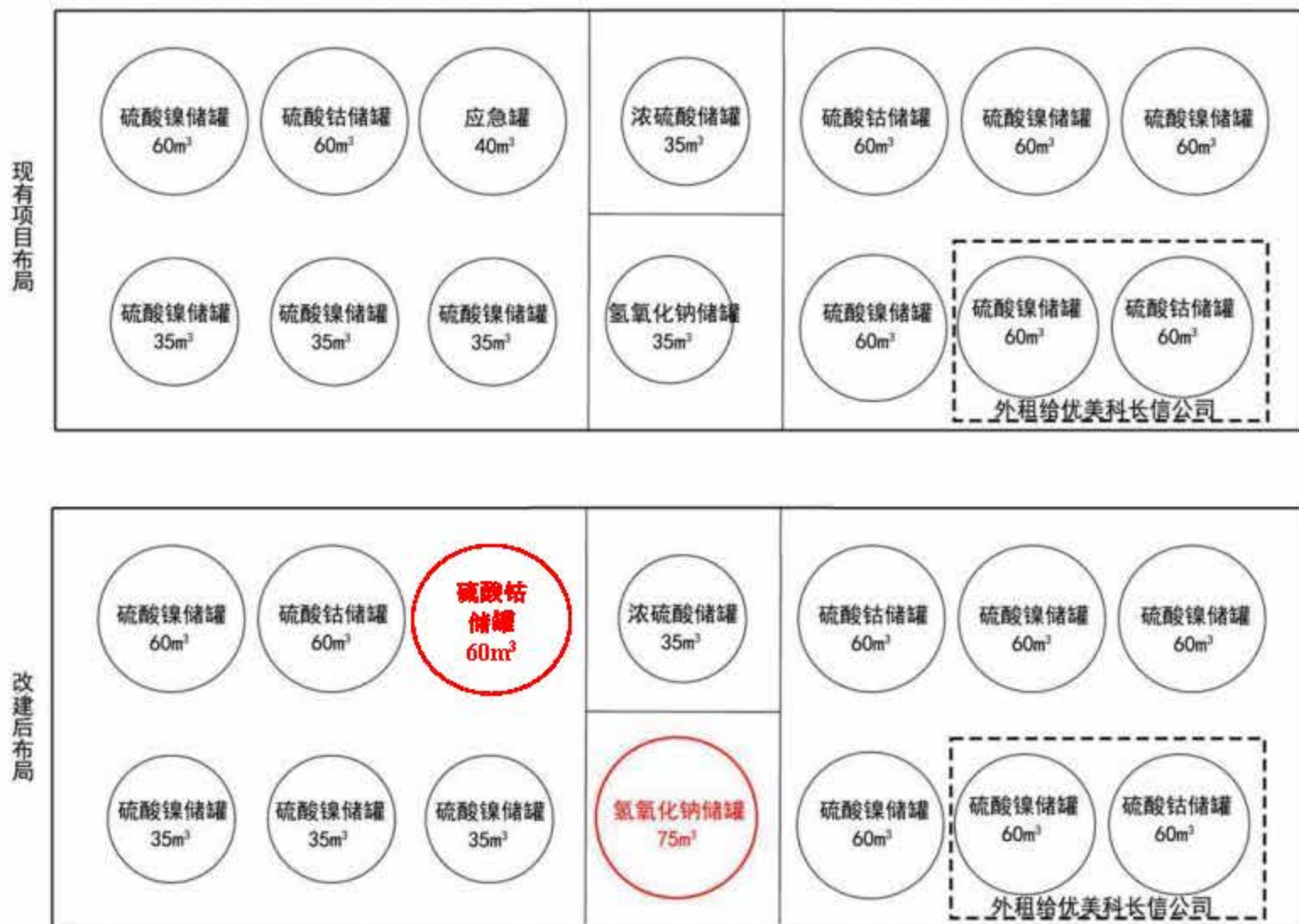
图 5-5 C 罐区改建前后布局示意图
