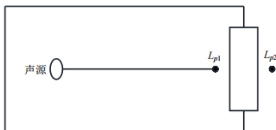
图 6.4-1 室内声源等效为室外声源图例
