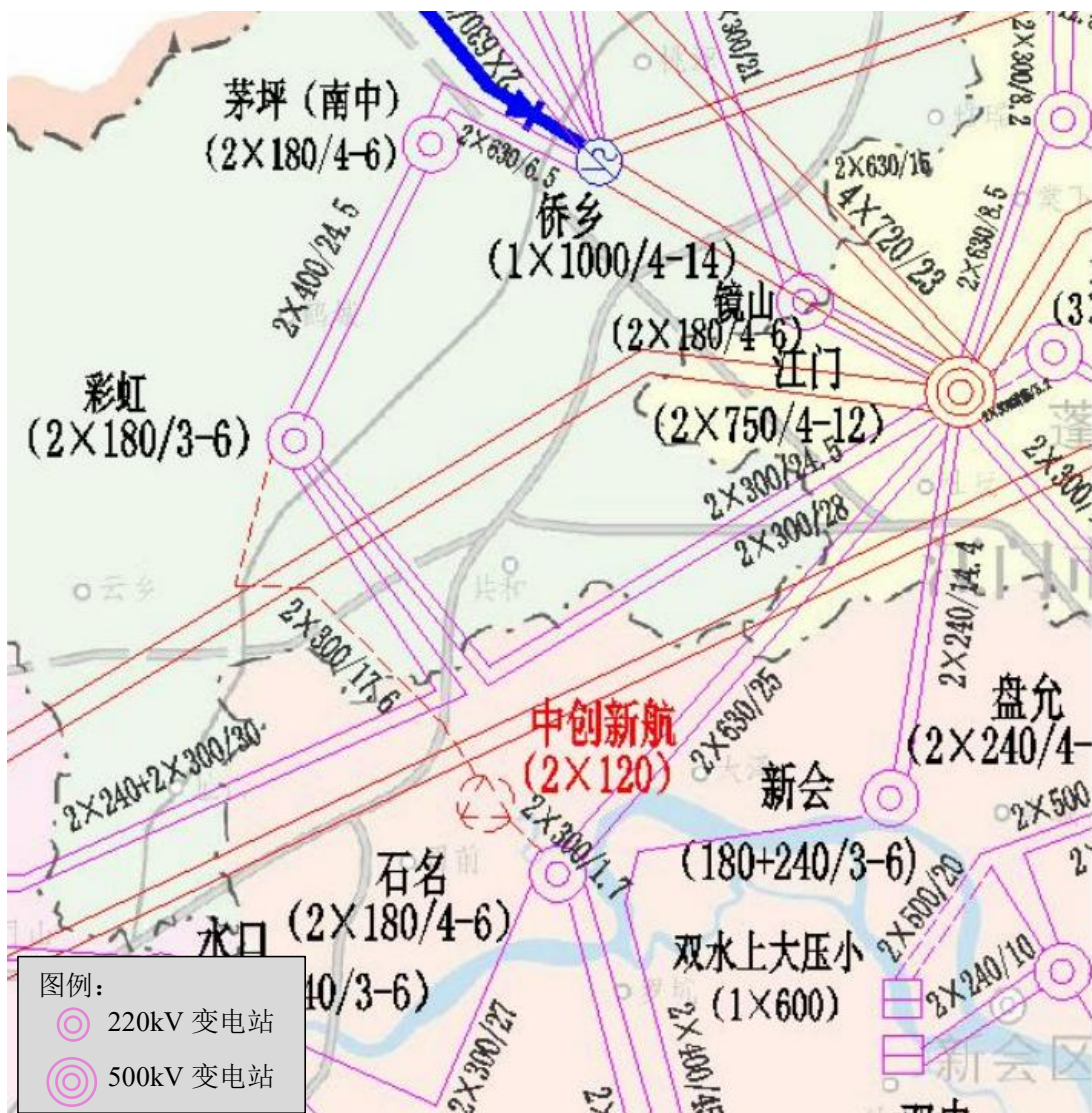
图 2-3 本工程接入系统方案示意图
