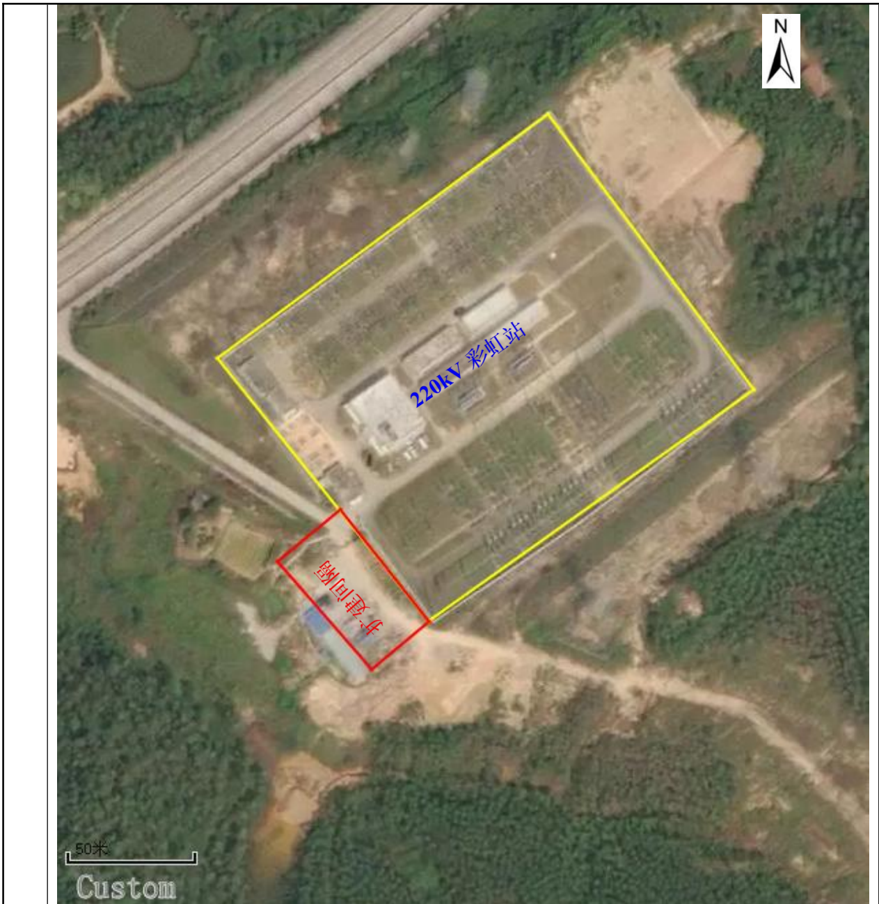
图 2-2 220kV 彩虹站站外扩建间隔平面示意图
