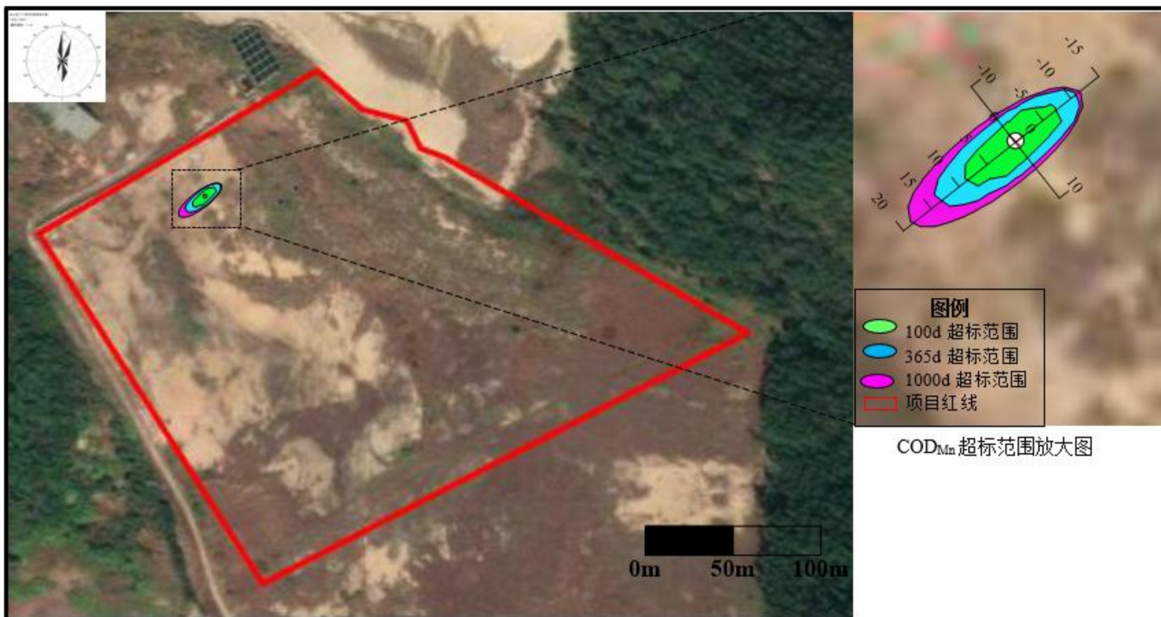
图 5.2.2.5-1 (b) 废包装桶处理车间溶剂清洗液池渗漏 \text{COD}_{\text{Mn}} 超标范围图
