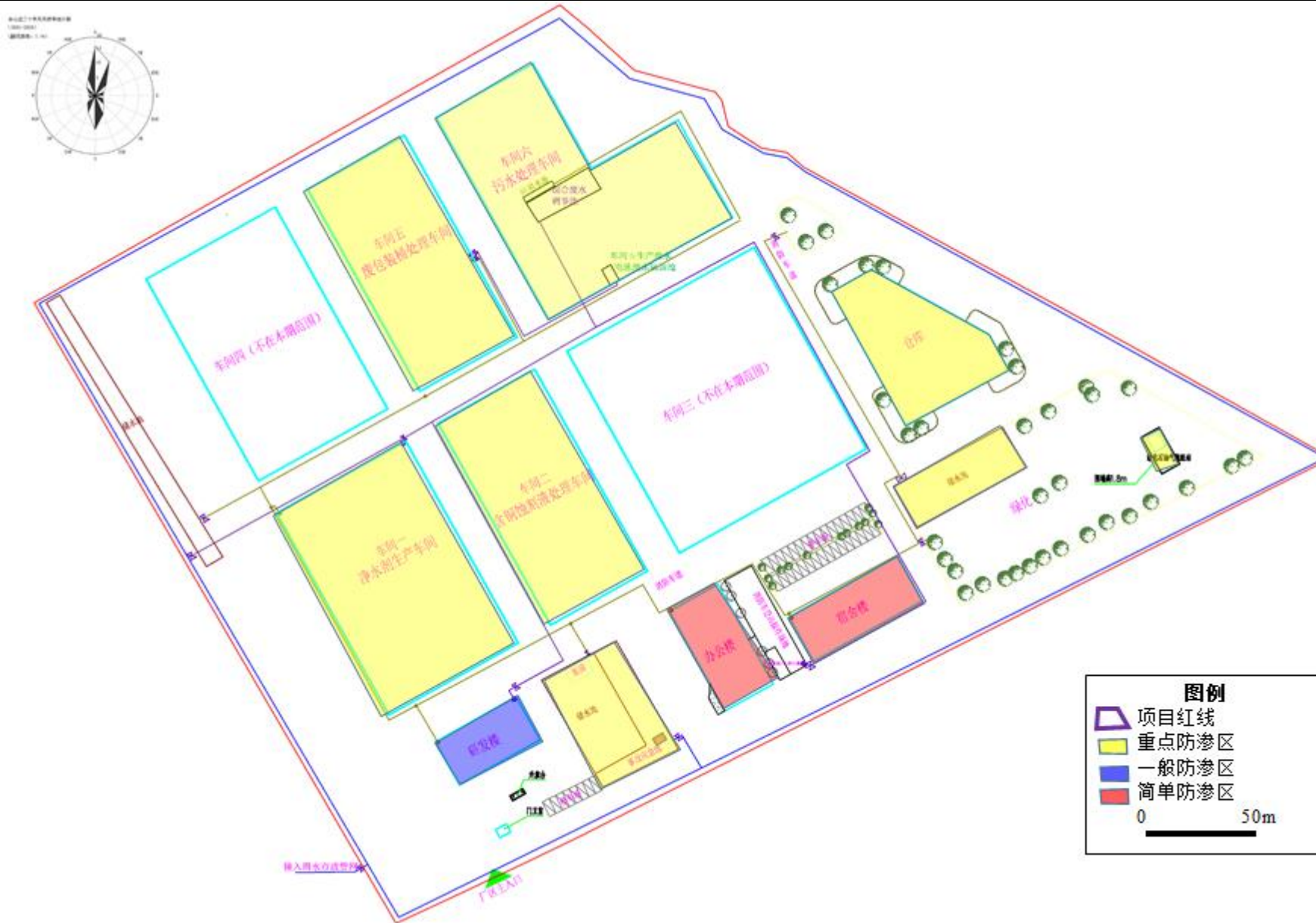
图6.3.3-1 地下水分区污染防治示意图
