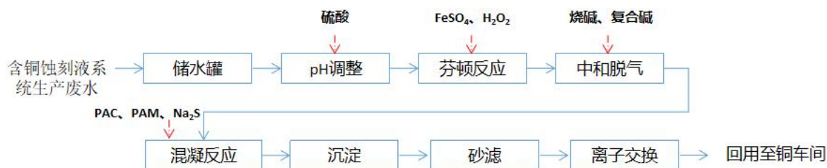
图6.1.1-1 含铜含铜蚀刻液处理车间废水处理回用设计方案图
