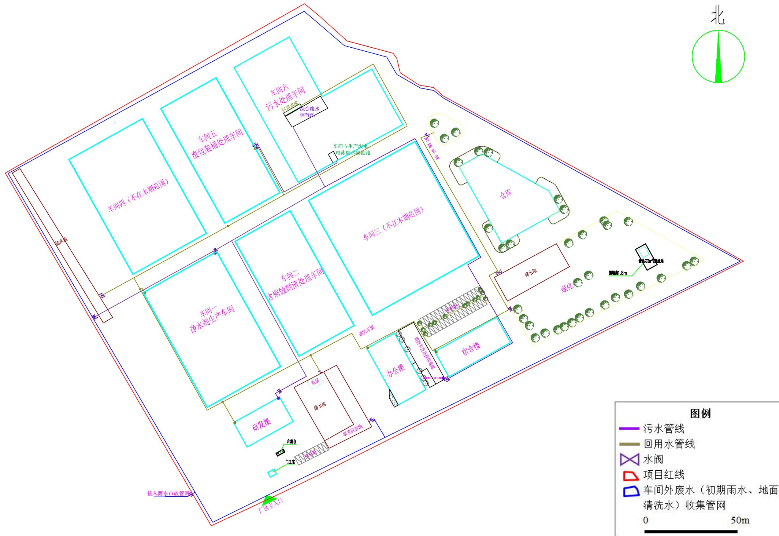
图 3.2.5.1-4 污水处理系统进水、回用水管网
