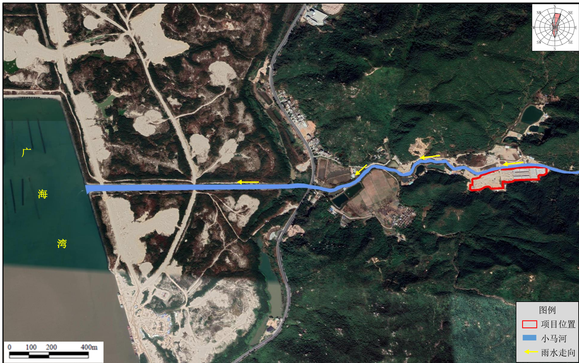
图6.2-8项目雨水路径排放示意图
