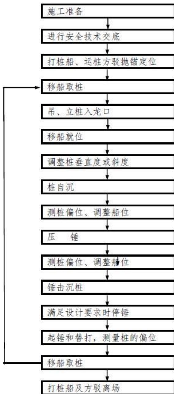
图 4.2-11 PHC 桩施工工艺流程
