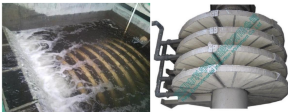
图 3.4-4 纤维转盘滤池
