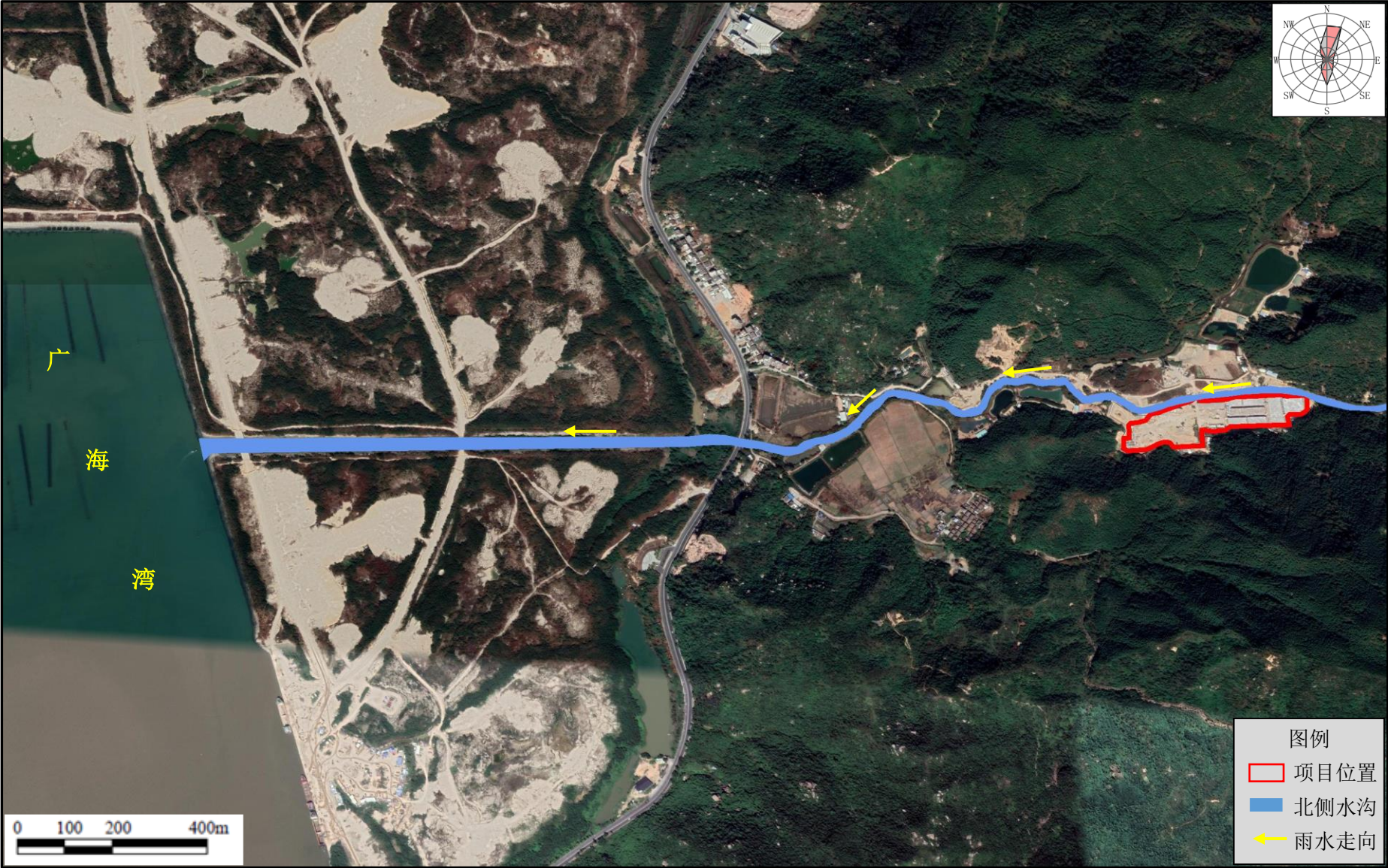
图6.2-8项目雨水路径排放示意图
