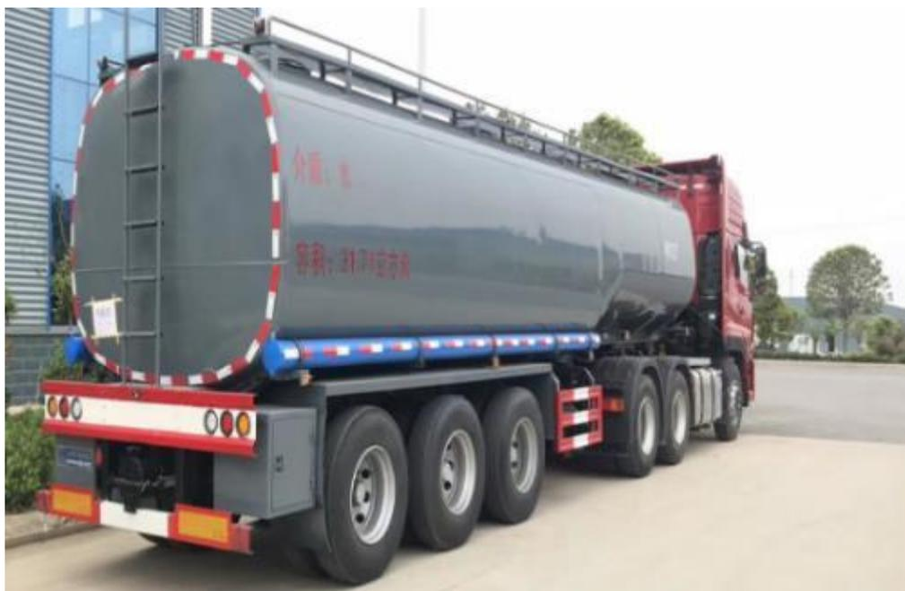
图 3.2.5.1-2 标准防腐防渗的封闭式专用槽罐车示例图
