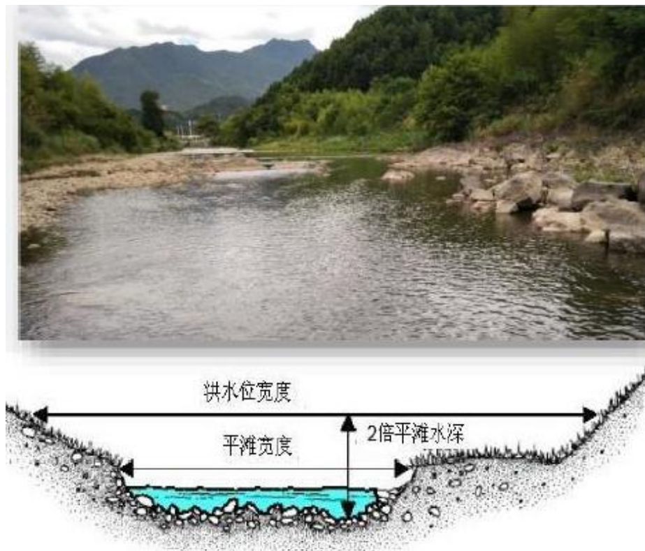
图 3.1.5-4 河道纵向深槽
