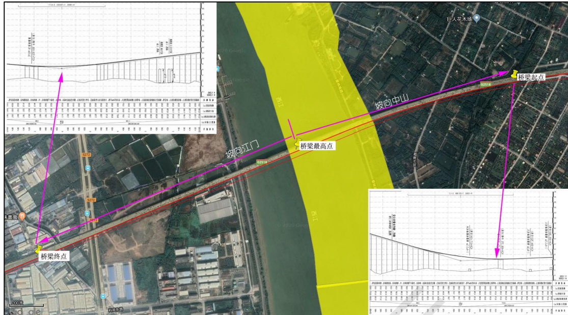
图 1.9-1 西江特大桥桥面径流汇流示意图
