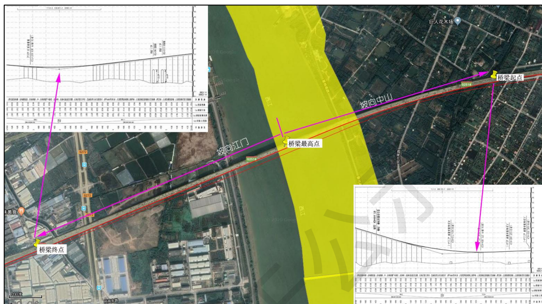
图 5.4-1 西江特大桥桥面径流汇流示意图
