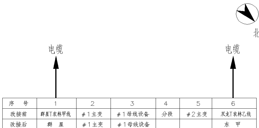
图 9 110 千伏白沙站 110 千伏出线
