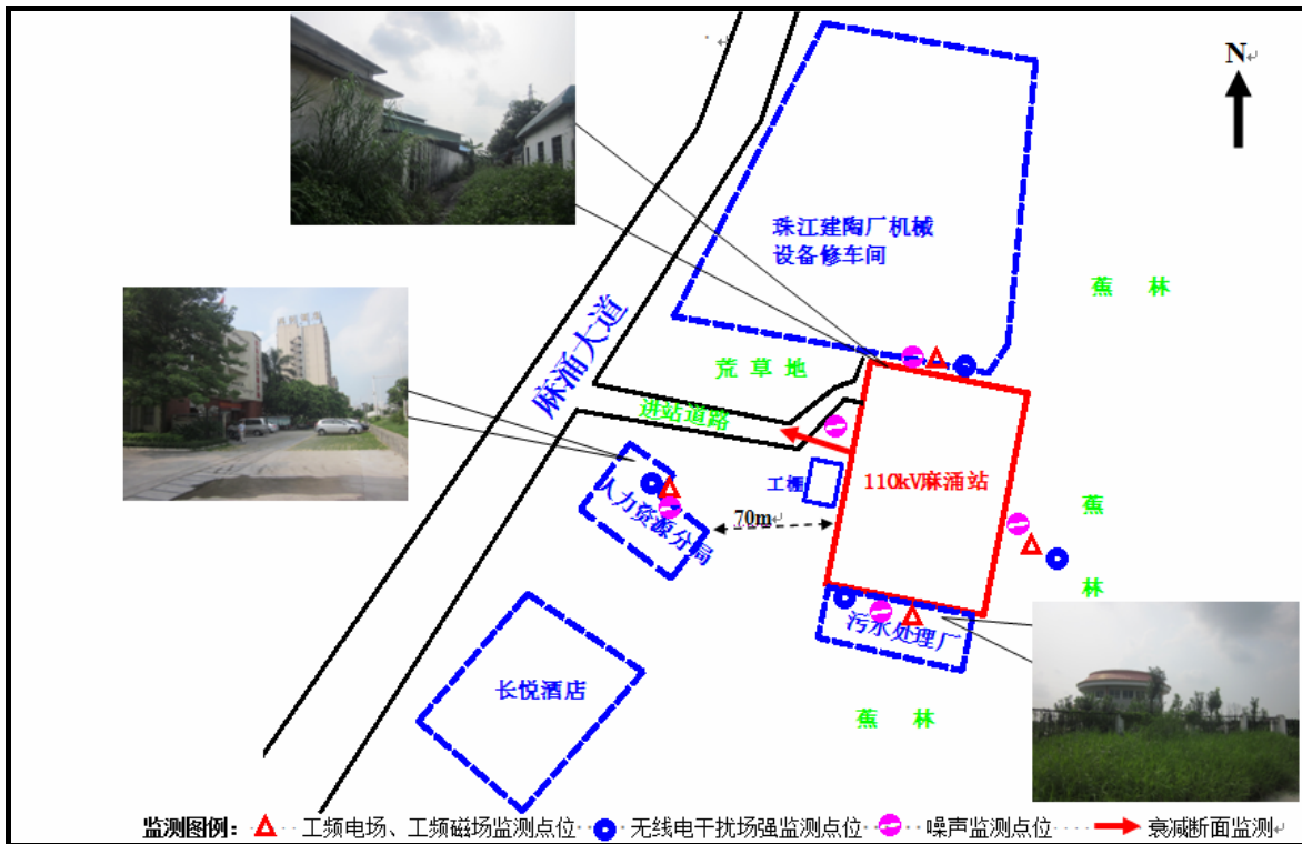
图 5 110kV 麻涌站监测布点图
